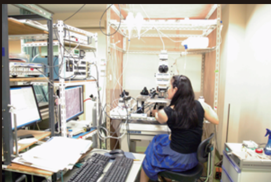
実験装置： 顕微鏡の画像がカメラを通してコンピューターの画面（右側）に映し出され ます。それを見ながら細胞に電極を近づけます。
